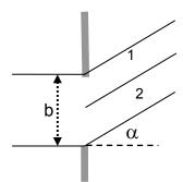
Bedingung für ein Maximum: Zerlegung des Strahls in 2m+1 Strahlbündel, von denen sich jeweils 2m auslöschen (Gangunterschied λ/2 für die Randstrahlen benachbarter Strahlbündel) und der 2m+1. Strahlbündel übrig bleibt.
